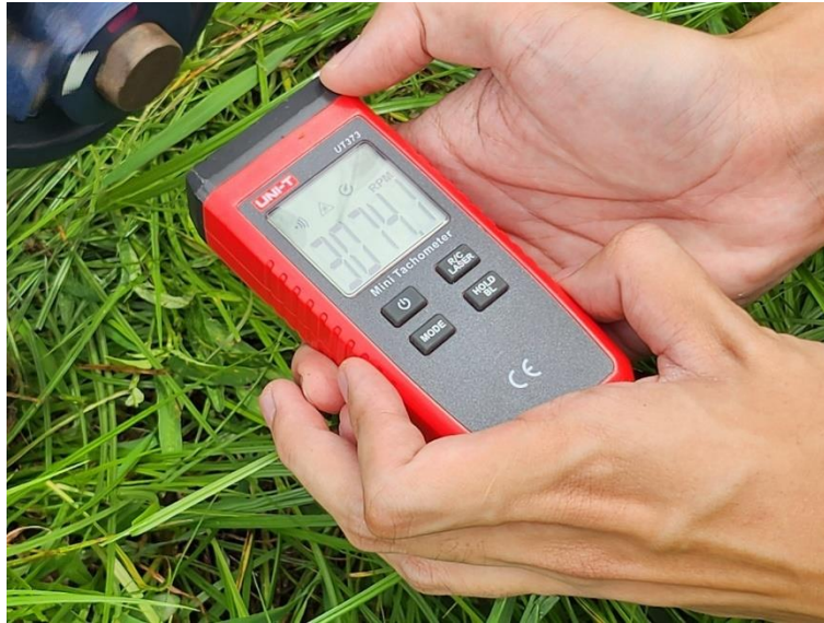
ภาพที่ 3.6 วัดความเร็วรอบของเพลาด้วยเครื่องวัดความเร็วรอบแบบแสง (Mini Tachometer)
