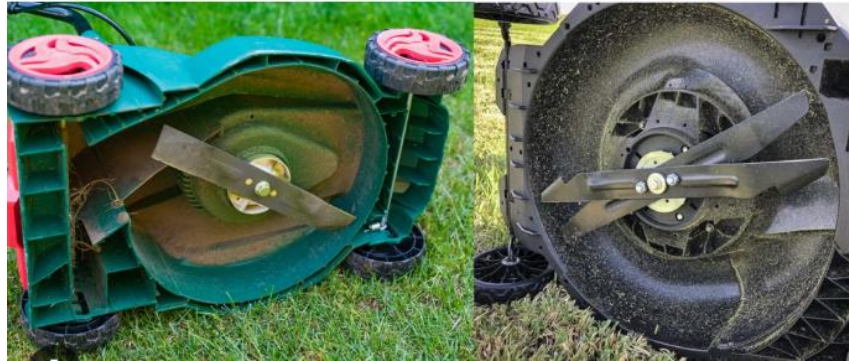
ภาพที่ 2.8 การตัดแบบใช้แรงเฉือน
