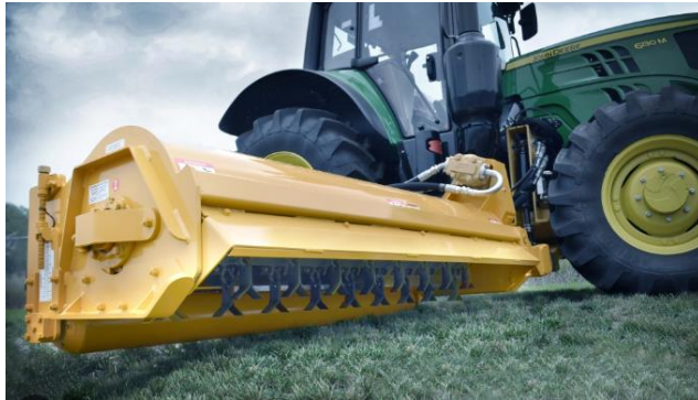
ภาพที่ 2.9 การตัดแบบกระแทบ ชนิดใบมีดหมุนในแนวตั้ง ที่มา : brushcutter.co, 2567
